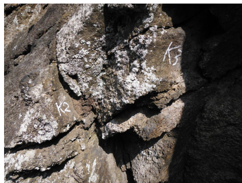
(d) Discontinuità K2 e K3 subverticali / Steil fallende Trennflächen K1 und K3
