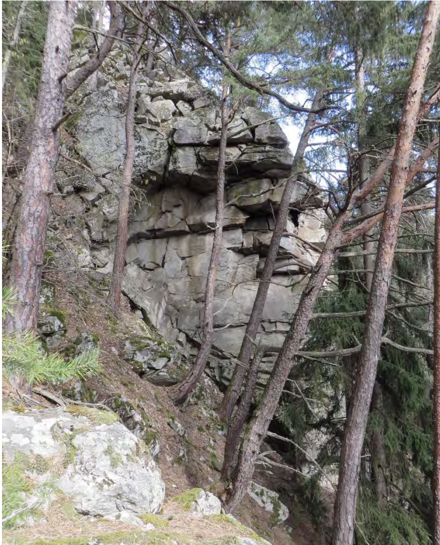
Zone A7: Blick Richtung E; im Grenzgleichgewicht befindende, stark aufgelockerte Zone mit ca. 300 m 3 Gesamtvolumen; max. Einzelblockvolumen 5,0-6,0 m 3 ; basale Harnischfläche Hf(115/58); Kluffflächen K1(130/85), K1'(150/50), K2(60/35), K3(220/60-75)
