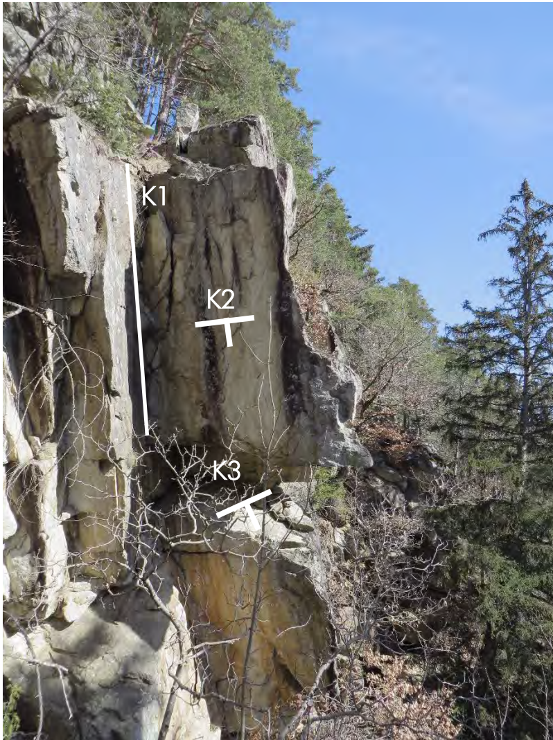
Zone B7: Zwei Klufkörper zu jeweils 20 m 3 und 25 m 3 , rückseitig von K1 (140/85), K2(250/65) und an der Basis von K3(210/25) begrenzt (Blick nach E)
